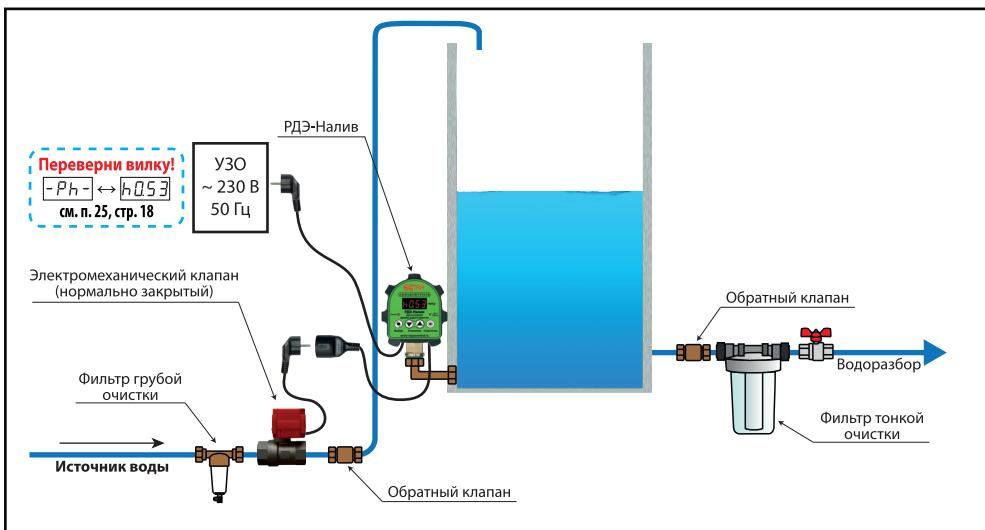
**Пример 3. Подключение РДЭ-Налив для управления однофазным насосом мощностью Р1 более 2.2 кВт, или трехфазным погружным насосом.**
