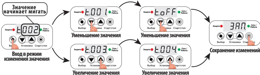
23.4 "П.XXX." – пауза до следующего включения насоса. Если во время работы насоса произошел переход РДЭ в режим паузы по параметру "т.XXX." (п. 23.3, стр. 15) или П.XXX. сработала защита по функции "дельта" (п. 23.1, стр. 14), то следующее его включение
