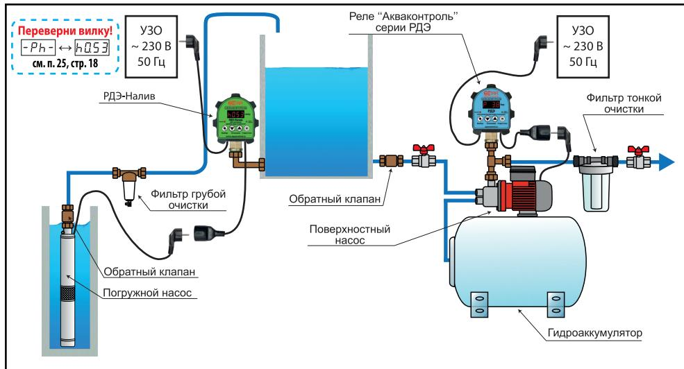
**Пример 2. Подключение РДЭ-Налив с электромеханическим клапаном на наполнение**
