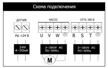
6.3 Подключение поверхностного насоса к прибору производится в его клеммной коробке (вместо использования штатного сетевого провода) или через специально оборудованную для этой цели розетку с заземляющим контактом.
