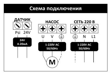
Однофазный ПЧ подключается к электросети кабелем с вилкой. Розетка должна быть с заземляющим контактом и надежным заземлением. Подключение ПЧ к насосу осуществляется кабелем с тремя накидными клеммами. Клеммы коричневого и синего провода — это фазовый (L1) и нулевой (N) провода, клемма с желто-зеленым проводом — это заземление.
