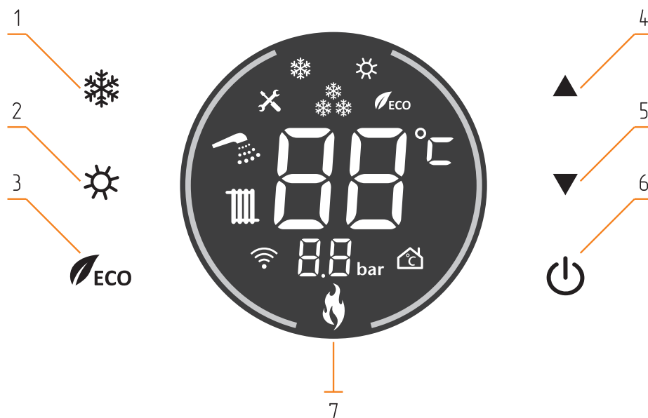
Рис. 10 Панель управления котла ZOTA PLASMA
