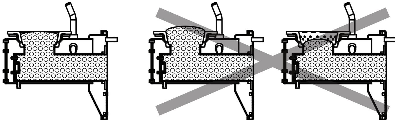
**Рис.13** Настройка уровня топлива при горении
